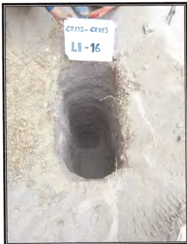
Foto N° 3 y 4: Ubicación de la calicata LI-16 se presenta un relleno conformado por arenas limosas, con gravas angulosas, con presencia de raíces y trozos de ladrillos en un espesor de 0.70m, subyaciendo hasta la profundidad explorada de 2.20m con arenas de grano fino, no plástica, de color beige, húmeda, con micas, en estado semicompacto.
