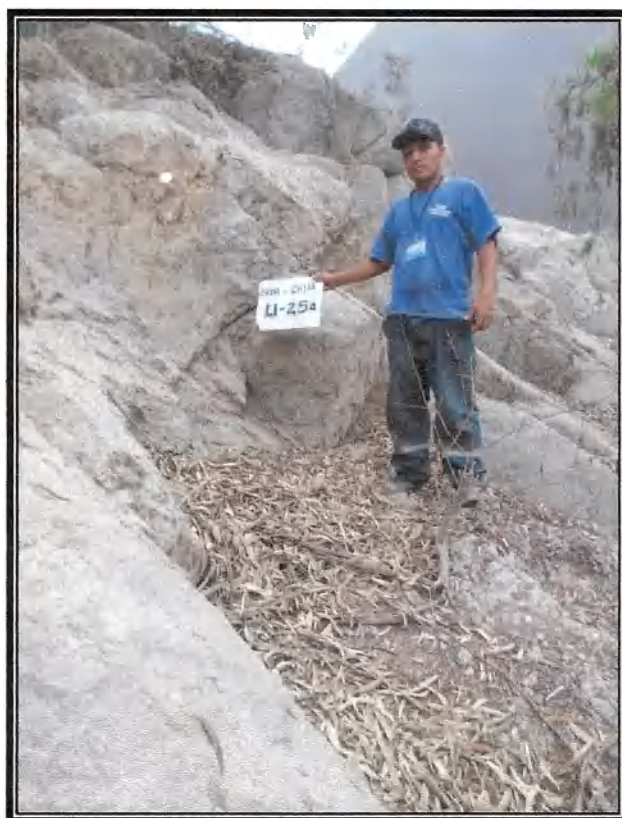
Foto N° 23 y 24: Ubicación de la calicata LI-25A (corte de talud) se presenta hasta la profundidad de 1.00m roca intrusiva (granodiorita), en estado sano de difícil excavación manual
