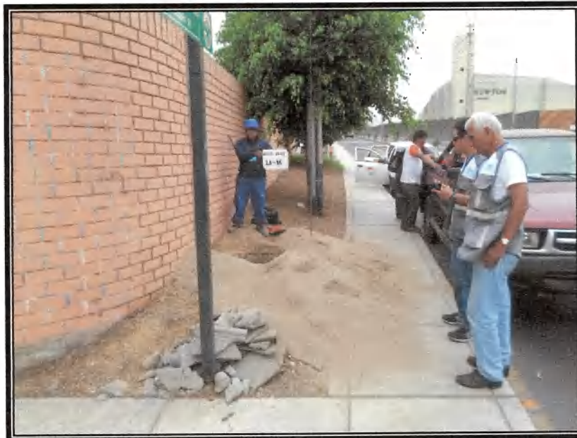
Foto N° 3 y 4: Ubicación de la calicata LI-16 se presenta un relleno conformado por arenas limosas, con gravas angulosas, con presencia de raíces y trozos de ladrillos en un espesor de 0.70m, subyaciendo hasta la profundidad explorada de 2.20m con arenas de grano fino, no plástica, de color beige, húmeda, con micas, en estado semicompacto.
