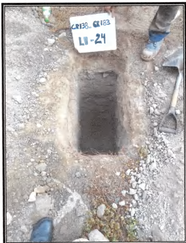
Foto N° 19 y 20: Ubicación de la calicata LI-24 se presenta un material removido conformado por arenas de grano grueso, con gravillas y raíces en un espesor de 0.30m, subyaciendo hasta la profundidad explorada de 2.00m con arenas con limos, de grano grueso, no plástica, de color plomizo, con gravas angulosas de \frac{3}{4} "-1" en un 5%-10%, en estado semicompacto a compacto.
