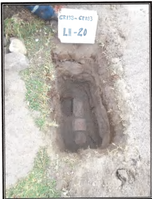
Foto N° 11 y 12: Ubicación de la calicata LI-20 se presenta un material removido conformado por arenas limosas, con gravas angulosas y raíces en un espesor de 0.40m, continuando hasta la profundidad de 1.50m un material removido, consistentes en arenas de grano grueso, no plástica, de color beige, húmeda, en estado semicompacto, subyaciendo hasta la profundidad explorada de 2.00m con arenas con limos, de grano medio a grueso, no plástica, de color beige, poco húmeda, con gravas angulosas de tamaño máximo 4", en estado semicompacto. Nota: a la profundidad de 1.00m pasa una tubería de concreto de diámetro 8".
